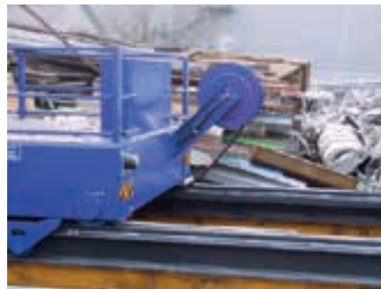
Die Stromversorgung erfolgt über eine Kabeltrommel. Damit kann die Maschine flexibel verfahren werden.
